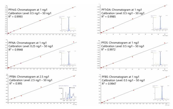
그림 2. 분석법 1: PFAS의 MRM 크로마토그램 및 검량선; Smoothing: standard Counts: 1 Width: 1; external calibration; Weighting: 1/C
