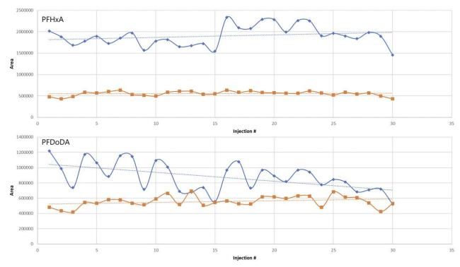
그림 4. 메탄올을 첨가한 경우(주황색)와 첨가하지 않은 경우(파란색)를 비교한 주입 횟수에 따른 안정성 곡선; PFHxA 및 PFDoDA의 내부표준물질을 통해 예시로 나타냄
