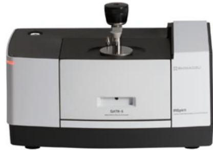
그림 1. QATR™-S가 장착된 IRSpirit™ FTIR
