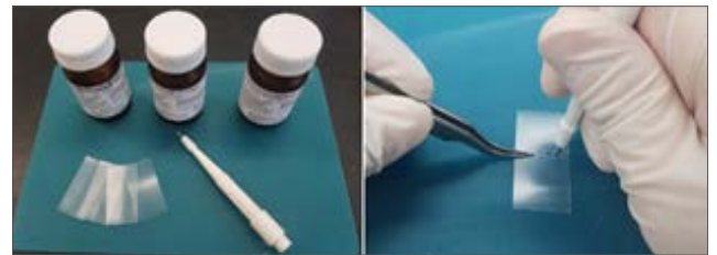
그림 2. 프탈레이트 에스터 표준물질과 전용 샘플링 도구 (Blank, 100 mg/kg, 1000 mg/kg의 세가지 농도로 구성)
