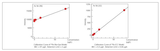
Fig. 1 <sup>56</sup>Fe Calibration Curves
